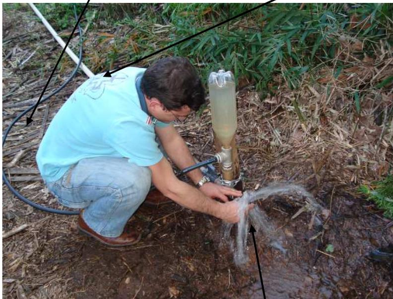
Válvula sendo regulada para abrir e fechar automaticamente de 40 a 50 vezes por minuto, conforme o fluxo de água
